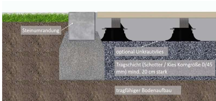
Bild 1. Die Tragschicht sollte ca. 20 cm stark sein.
