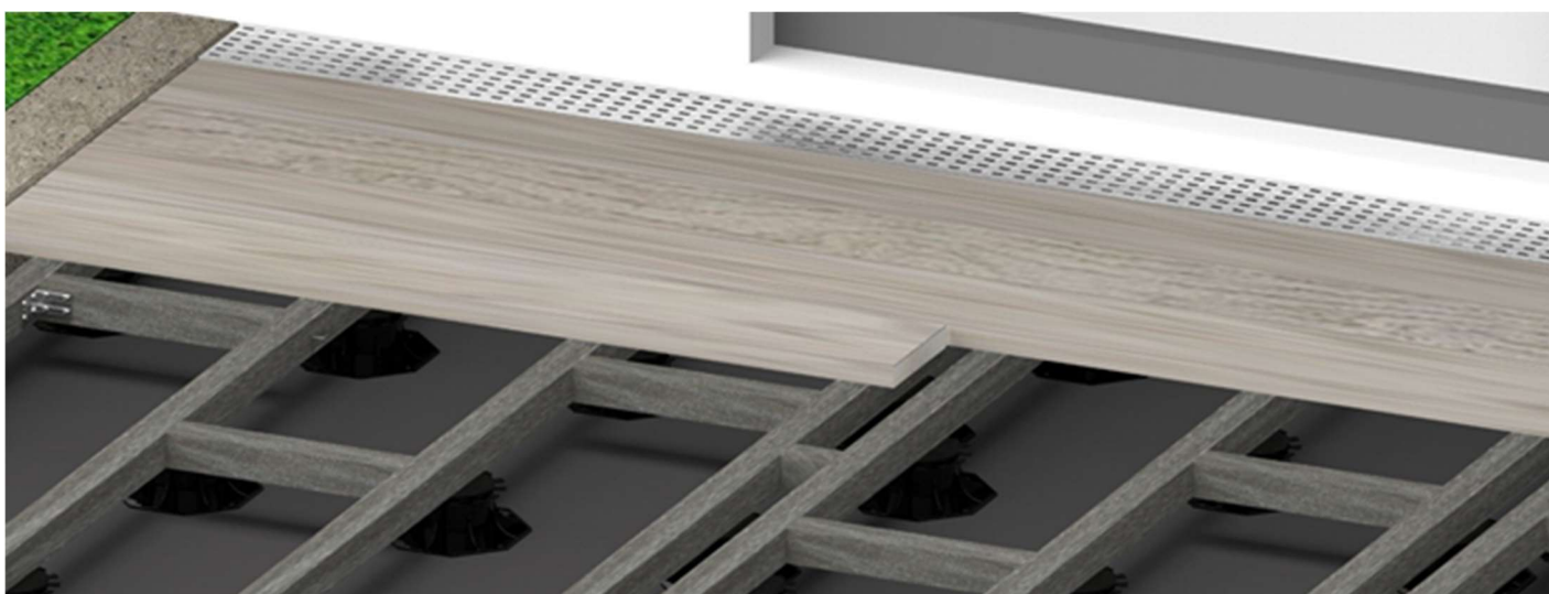
Bild 15. Terrassendielen können auf 2 Unterkonstruktionen in der Länge mit offenen Fugen gestossen werden (Bild 15) oder alternativ in der Mitte einer einzelnen Unterkonstruktion mit mind. 20 mm Auflager je Diele und einem Spalt von 2 mm in der Stossfuge.
