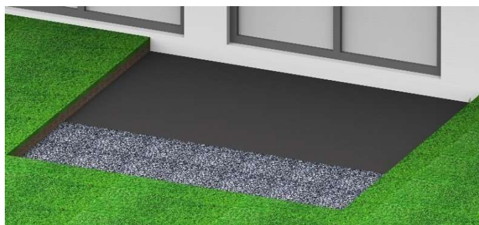
Bild 2. optional kann ein Unkrautvlies verwendet werden.
