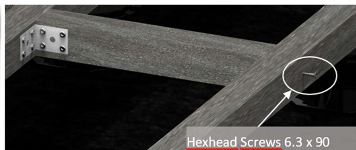
Bild 9. Die Querstücke werden direkt mit der UK verschraubt.
