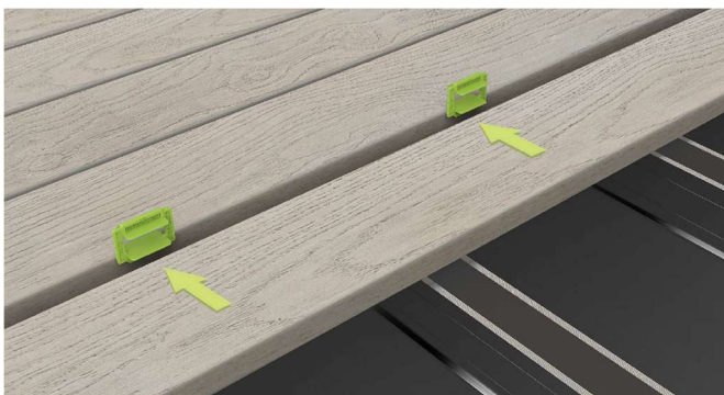
Platzieren Sie die Multi-Spacer (grün) mit der 6 mm Markierung in den Spalt zwischen zwei Dielen und schieben Sie diese zusammen, bis sie satt am Multi-Spacer anliegen
