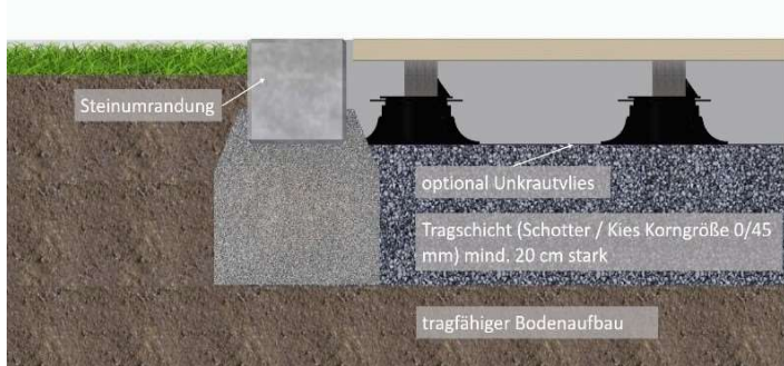
Bild 1. Die Tragschicht sollte ca. 20 cm stark sein.
