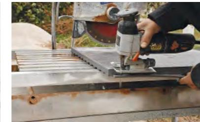
15. Schneiden des PUR-Kunststoffes mittels Stichsäge mit Laminat-Sägeblatt.
